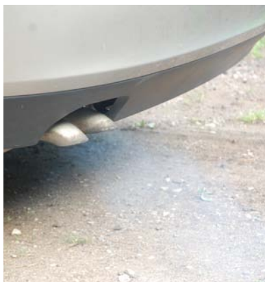
Po studeném startu (a to i v letním období) se z výfuku valil bílý kouř. Žhavení přitom fungovalo normálně.
